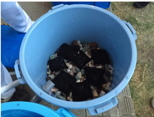
水ろ過装置（ろ過工程に砂利・竹炭を使用）
