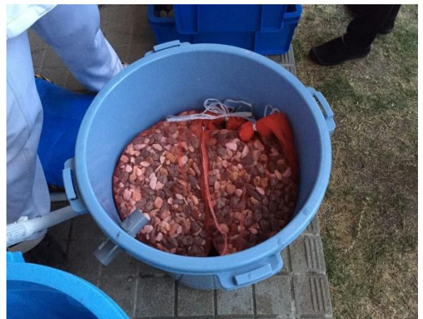
水ろ過装置（ろ過工程に砂利・竹炭を使用）
